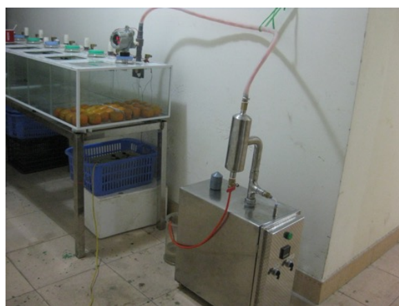
Hình 1. Mô hình thiết bị thí nghiệm xử lý dầm chín quả hồng bằng khí ethylene ngoại sinh
