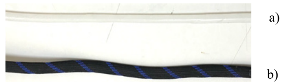
Hình 5. Ống dẫn nở được đúc bằng silicon lỏng (a); và sau đó được bọc lưới (b)
