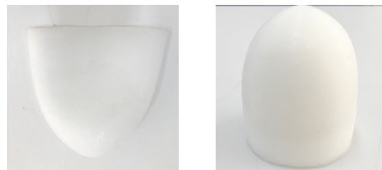
Hình 6. Bộ phận bao tim được đúc bằng silicon lỏng
