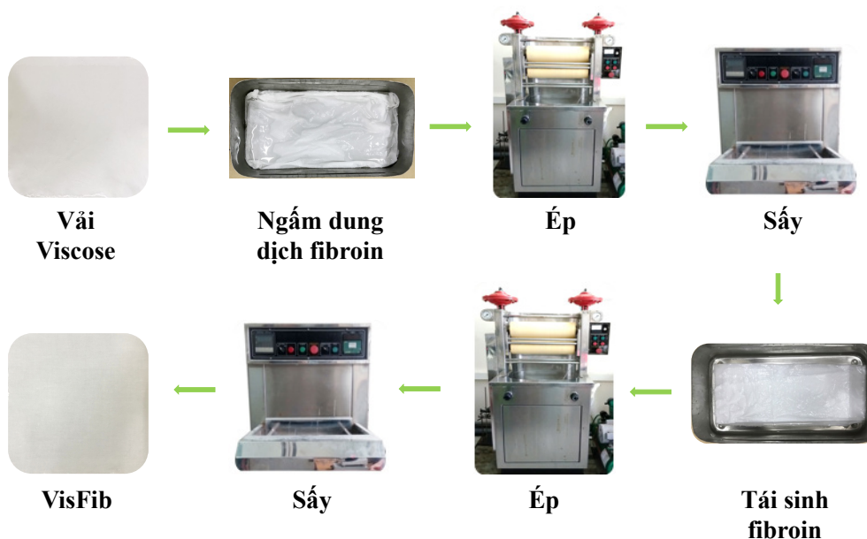
Hình 2. Quy trình xử lý hoàn tất vải viscose dệt thoi bằng dung dịch fibroin tơ tằm.
