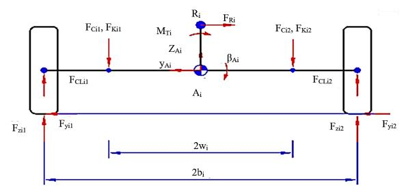
Fig. 3. Model of unsprung masses
