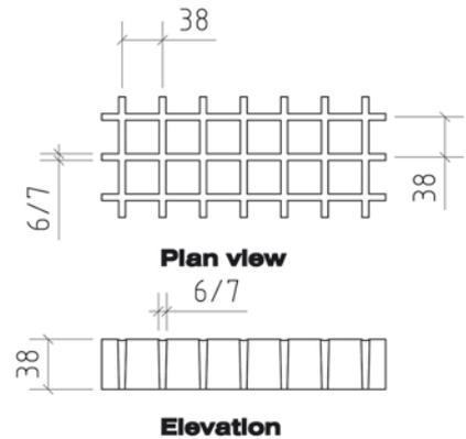
Gitterroste in dieser Höhe sind auch in Standard 2000 x 1000, 2440 x 1220, 3048 x 915 und 3660 x 1220 mm erhältlich. Es gibt auch verschiedene Panel-Größen in den Höhen 25 und 30 mm.
