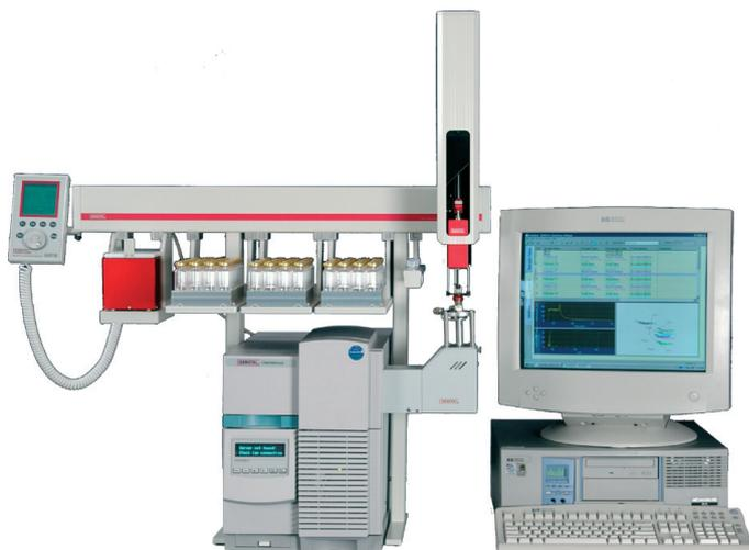
**Figure 1.** Gerstel Headspace ChemSensor.
