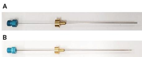
**Figure 1.** A) 85 µm CAR WR/PDMS Fiber.
