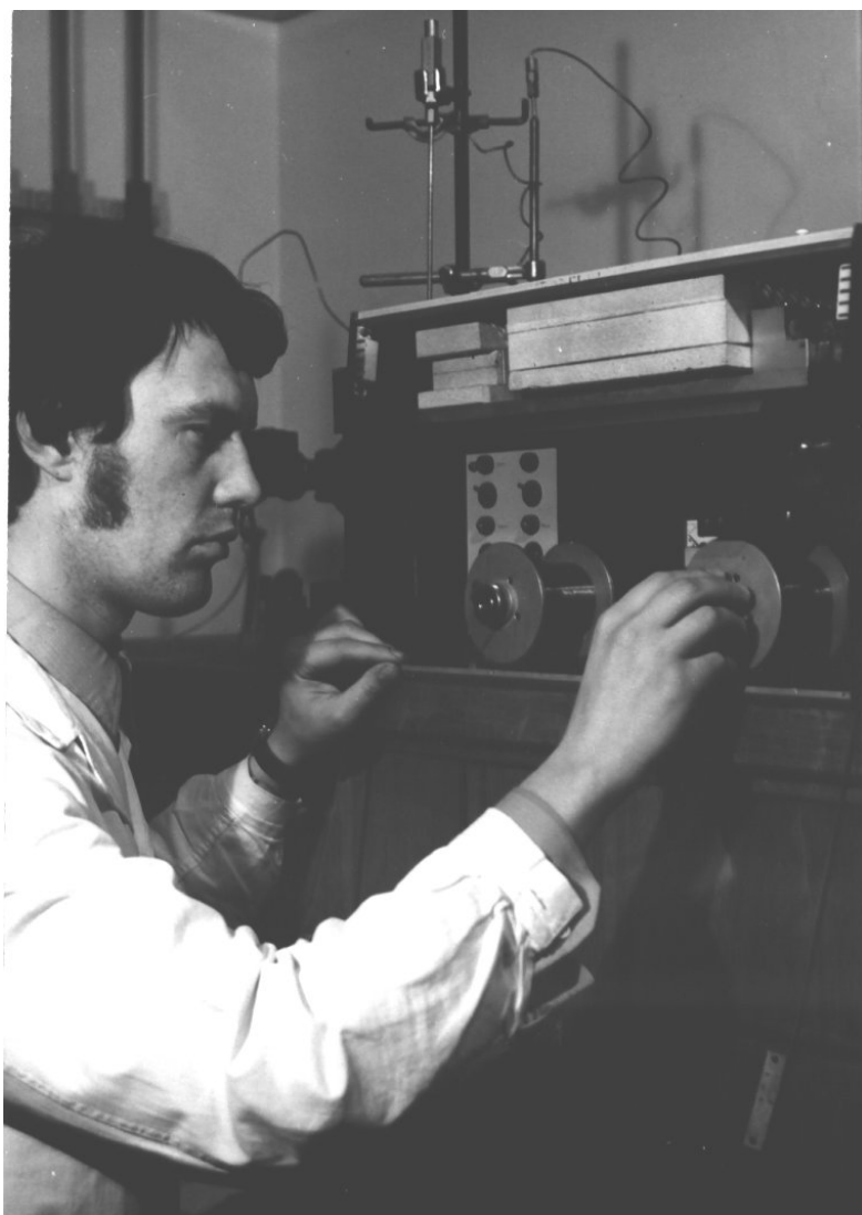
Obr. 2: Autor u drátového transportního detektoru. V pozadí nahoře na stojanu kolona s dávkovačem a předkolona.
