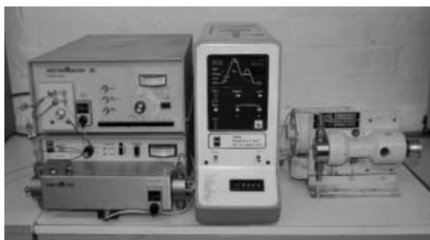
Obr. 1: LDC přístroj: vlevo dole Constametric pumpa, nahoře UV detektor, vpravo Milton Roy pumpa, uprostřed manuální integrátor.
