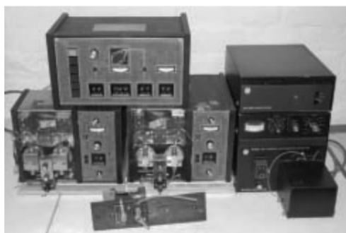
Obr. 2: Waters přístroj se dvěma pumpami M6000, RI401, UV a fluorescenčním detektorem Kratos.
