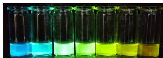
Obr. 1. Štruktúra vybraného cílového derivátu (nahore) a jeho solvatochromné chováni (fotka pořízena při ozařování ruční UV lampou \lambda_{exc}=245 nm)(dole)
