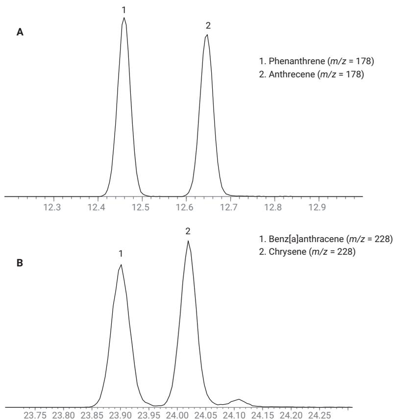
**Figure 7.** Resolution of critical pairs on a J&W VF-5ms Intuvo GC column.
