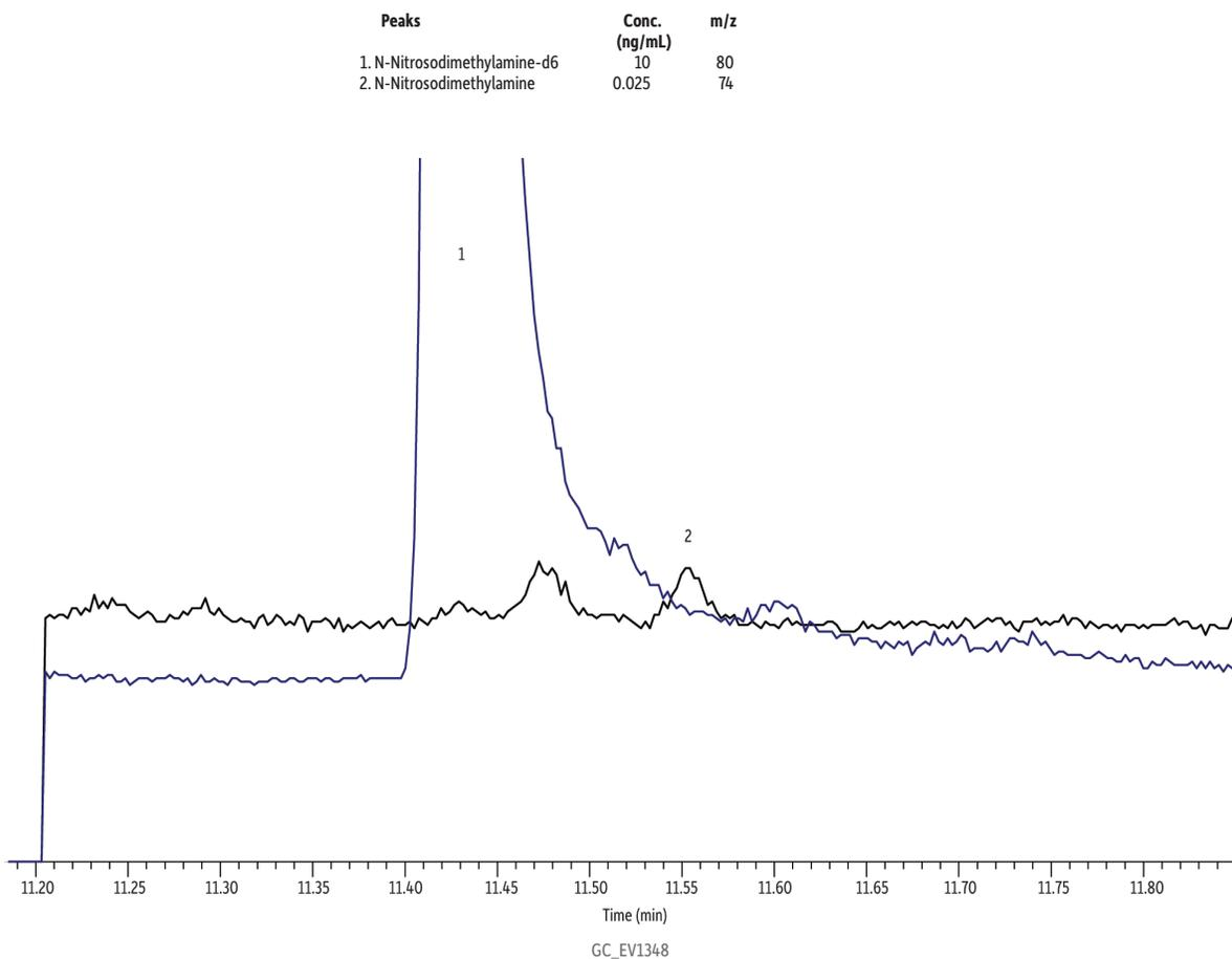
**Column** Rxi®-5Sil MS, 30 m, 0.25 mm ID, 1.00 µm (cat.# 13653)
