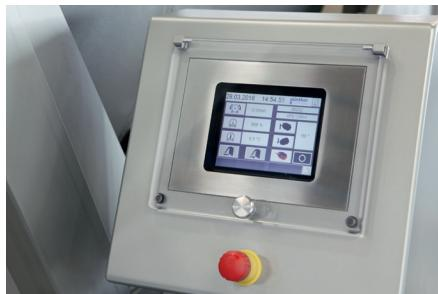
Alle Anlagenfunktionen und Prozess-Programmabläufe werden über einen Sensor-Monitor gesteuert. All process data and functions are handled via touch screen operator panel. Todas las funciones y secuencias de programas se controlan por medio del teclado de membrana con display integrado.
