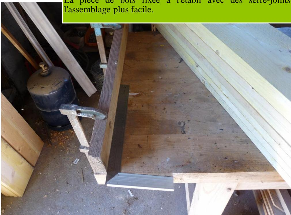
La pièce de bois fixée à l'établi avec des serre-joints rend l'assemblage plus facile.
