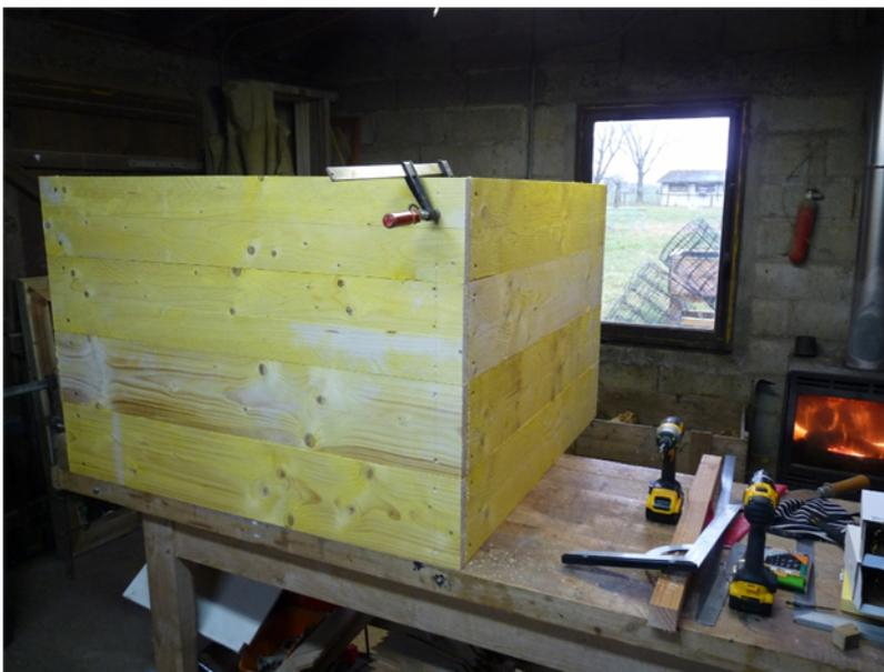
**Le 3ème côté se fixe sans difficulté car les angles sont déjà en place. Il suffit de présenter le 3ème côté toujours tête en bas, de le fixer avec un serre joint. Commencez par visser une vis en bas et vérifiant les affleurements, puis une vis tout en haut pour que l'ensemble ne bouge plus. Vissez le reste.**
