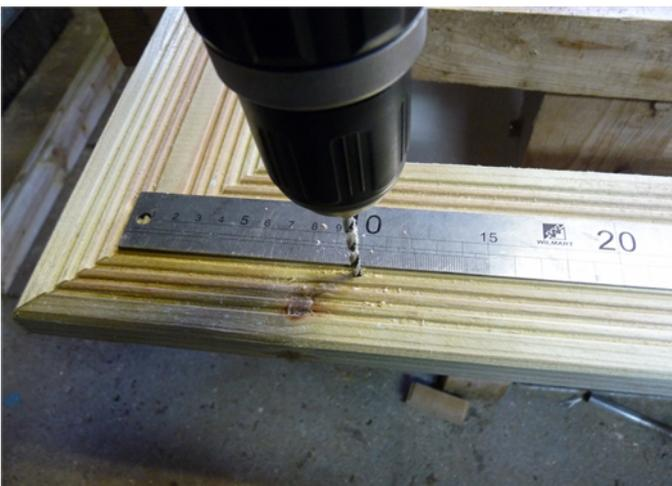
**Percez l'emplacement des vis pour la fixation du cadre sur le bac. 3 Vis par lame. 2 vis a 10cm du bord et une vis au milieu à 62cm. Vos vis doivent tomber dans la 2eme rainure en partant du plat central.**
