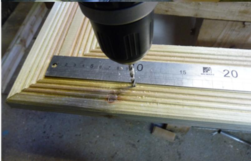
Percez l'emplacement des vis pour la fixation du cadre sur le bac. 3 Vis par lame. 2 vis à 10cm du bord et une vis au milieu à 62cm. Vos vis doivent tomber dans la 2ème rainure en partant du plat central.
