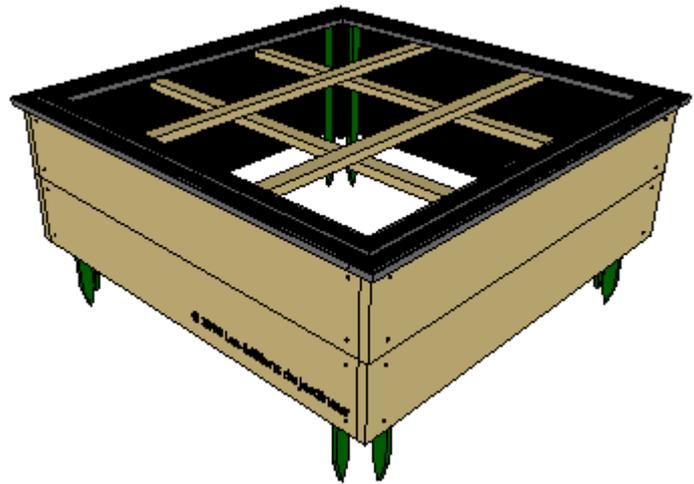
Avec les tasseaux de 14x37mm, coupez 4 pièces de 1140mm. Ne les fixez pas à la structure du carré, pour les enlever facilement.
