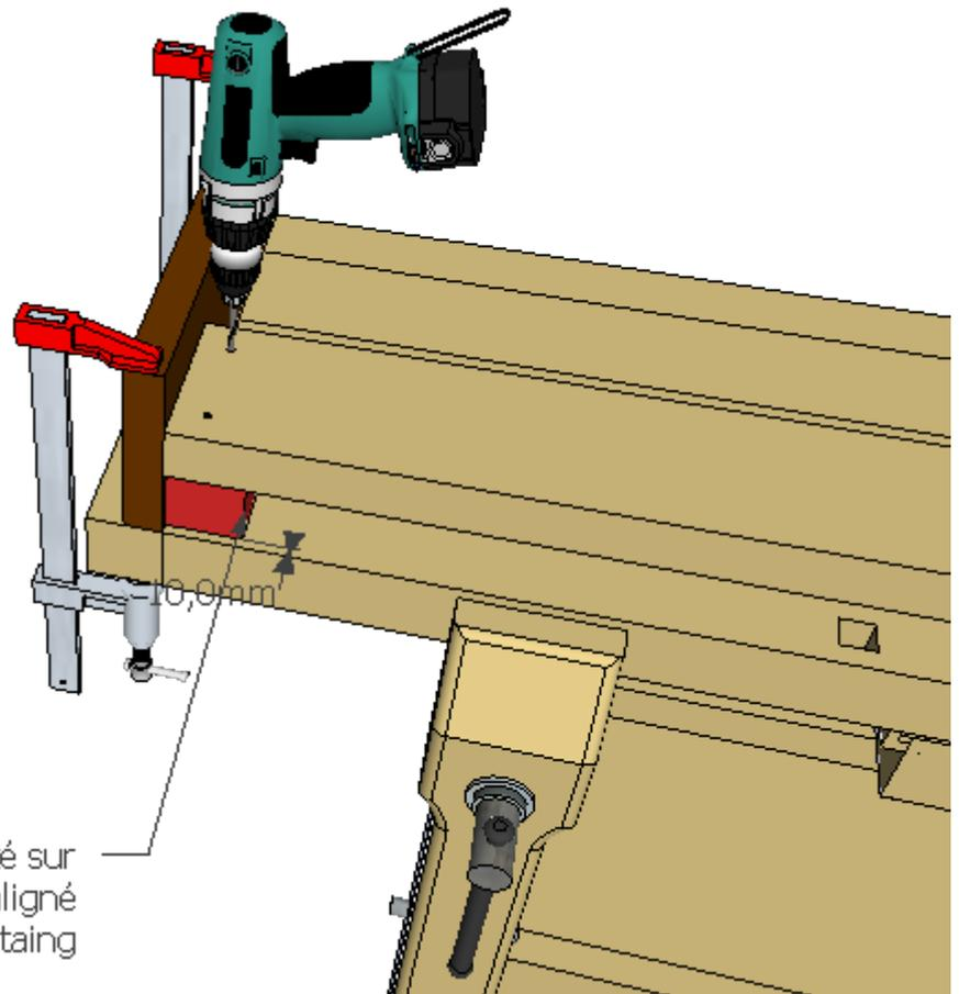
Placez les poteaux en buté sur la cale. Les poteaux ne sont pas aligné avec les bastaing
