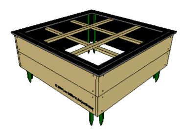
Avec les tasseaux de 14x37mm, coupez 4 pièces de 1140mm. Ne les fixez pas à la structure du carré, pour les enlever facilement.
