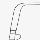
Braccioli regolabili in altezza tramite sistema "step by step", supporto in poliammide
