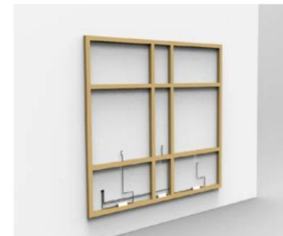
1. Den Tragrahmen erstellen und die Stromanschlüsse für die einzelnen Buchstaben vorbereiten.
