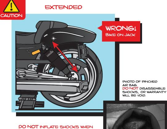
DO NOT INFLATE SHOCKS WHEN BIKE IS OFF OF THE GROUND AND SHOCKS ARE EXTENDED.
