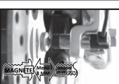
Per ottenere un segnale velocità di buona qualità, la distanza tra il sensore di velocità e il magnete deve essere inferiore a 8 mm.
