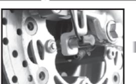
Installare il sensore di velocità sulla staffa.
