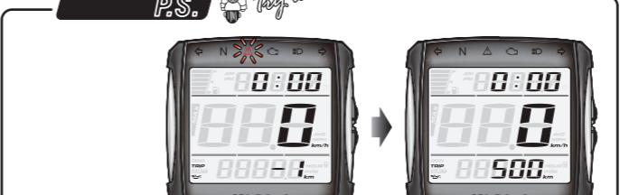
● Cuando la distancia recorrida llegue a la configuración de distancia de mantenimiento. La luz indicadora de aceite se iluminará. La luz indicadora se puede apagar tras poner a cero los registros.
