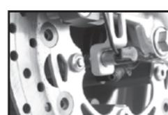
Instale el sensor de velocidad en el soporte.
