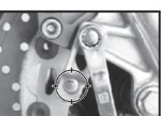
Ajuste la posición del soporte del sensor para asegurar que el sensor esté frente al imán para recibir una buena señal de velocidad.
