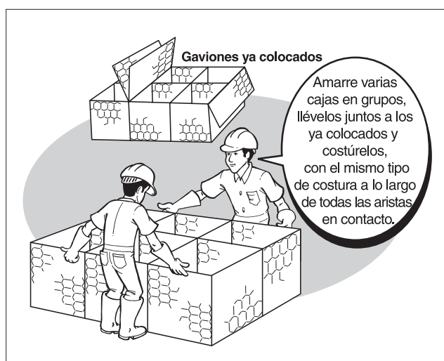
Figura 4.2.5 – Posicionamiento de los gaviones antes de su llenado
