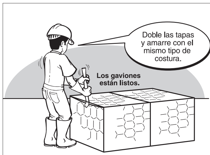
Figura 4.2.10 – Detalle de la etapa de cierre del gavión tipo caja
