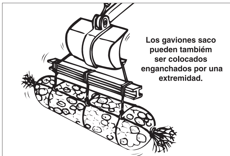
4.2.19 - Posicionamiento de los puntos de izado
