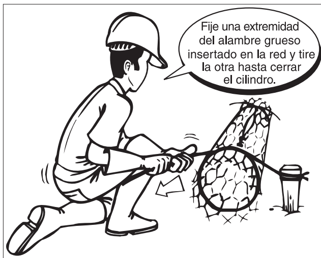
Figura 4.2.13 – Amarre y cierre de las extremidades del gavión tipo saco
