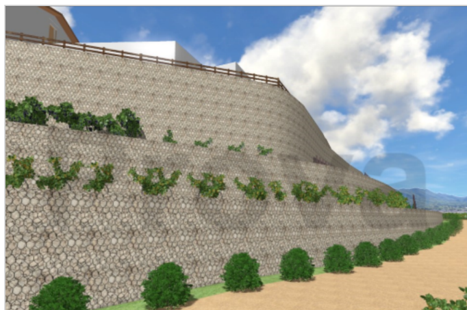
Render muro de gaviones al final de los trabajos
