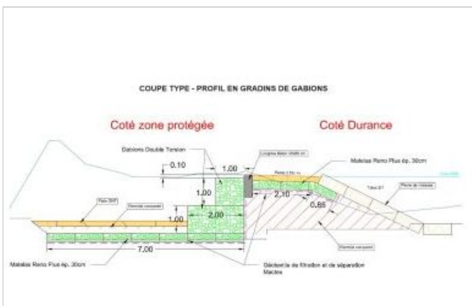
Coupe type - Profil en gradins de gabions
