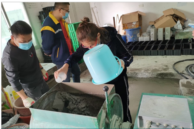
图3 钢纤维混凝土配合比验证
