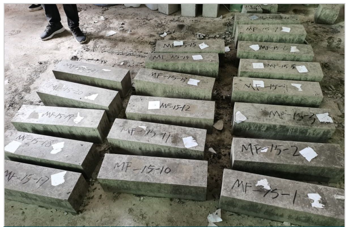
图4 项目所在地同条件钢纤维混凝土测试试件制作
