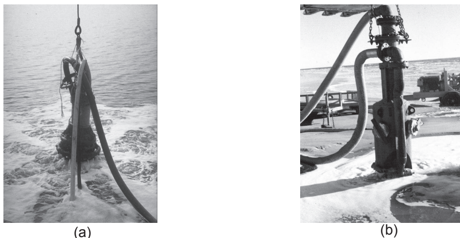
Figura 4.4.12 – Equipamiento de dragaje. a) Dragas operando dentro del agua; b) dragas operando fuera del agua.
