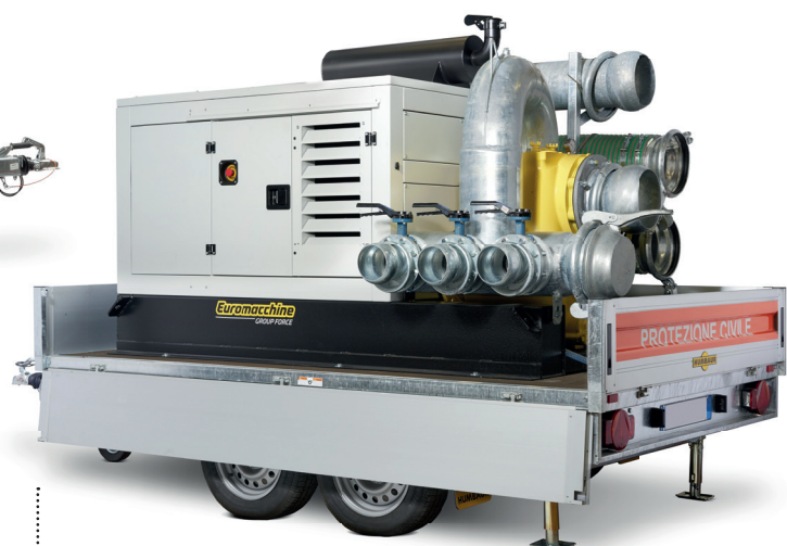
Hangszigetelt SZIVATTYÚ EGYSÉG 800 m 3 /h
