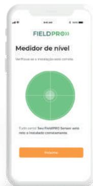
El nivel de burbuja que se mueve en la pantalla de su teléfono celular debe colocarse justo en el centro. La burbuja se volverá verde cuando esté en el centro, lo que indica que el sensor está recto e instalado correctamente.
