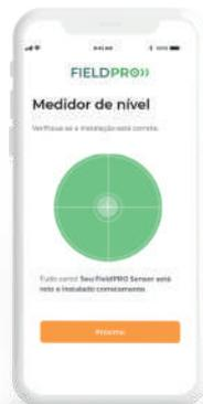
A bolha que se movimenta deve ficar posicionado bem ao centro e mostrar a cor verde, indicando que o seu Sensor está reto e instalado corretamente.
