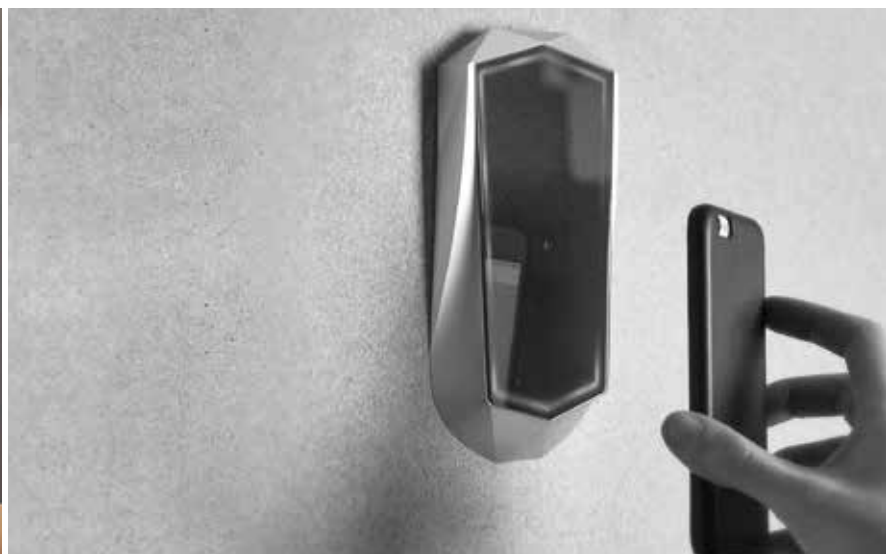
Der LightPass wird auf dem Smartphone aufgerufen und von einem Lesegerät gescannt.
