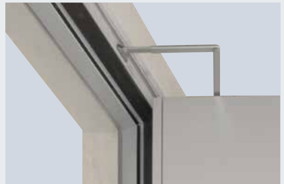
Slepi podboj 140 / 75 mm, 3-delni s 3-stranskim utorom za neprekinjeno tesnilo
