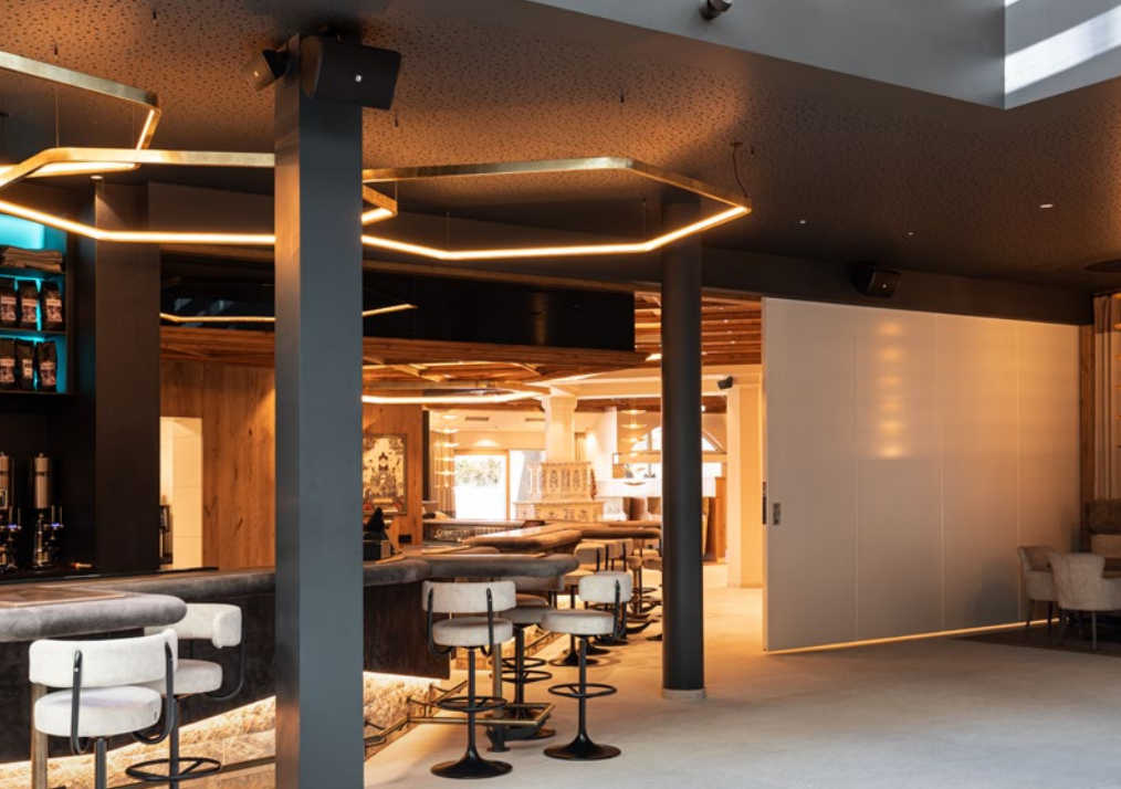
ZGORAJ LEVO. Ognjevarna drsna vrata FST 30-T3 OD, teleskop 3-delni, standardno bela RAL 9016
