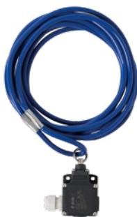
Potezno stikalo z vrvjo Montaža je možna vodoravno ali navpično, ohišje iz aluminijaste tlačne litine IP 65, dolžina vrvi 4 m
