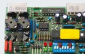
Analizator induktivnih zank vtično vezje 1- ali 2-kanalno, primerno za 2 ločeni induktivni zanki, dobava brez kabla z zankami
