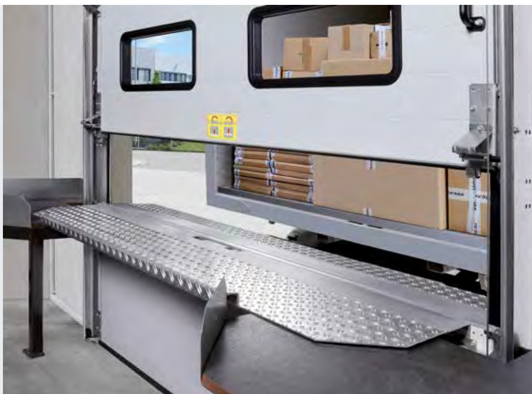
Površina za upravljanje omogoča enostaven dostop do nakladalne površine tovornjaka.
