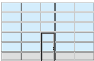
Izvedba osebnega prehoda na sredini
