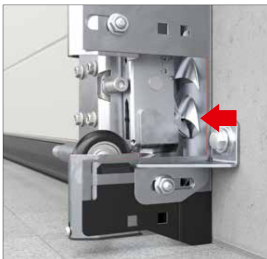
Zapahnitveni kavelj varovala pred odpiranjem se med dvigovanjem vrat avtomatsko fiksno zaskoči.
