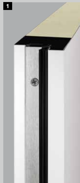
Varnostna vrata KSI Thermo46 so prepričljiva z vratnim krilom debeline 46 mm in zelo dobro toplotnoizolacijsko vrednostjo do 1,1 \text{ W}/(\text{m}^2 \cdot \text{K}) .
