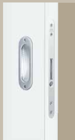
Z izskočnim držalom lahko vratno krilo drsnih vrat, ki se pomika v steno, v celoti potisnete v steno. S pritiskom na gumb držalo izskoči in vrata lahko zaprete.
