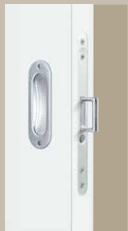
Z izskočnim držalom lahko vratno krilo drsnih vrat, ki se pomika v steno, v celoti potisnete v steno. S pritiskom na gumb držalo izskoči in vrata lahko zaprete.
