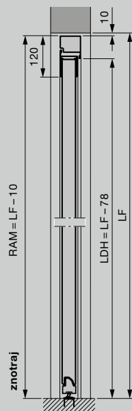
Stranska vrata z aluminijastim slepim podbojem tip profila 2 Vgradnja v odprtino
