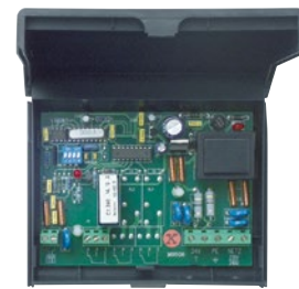
Ohišje dekodeja za kodna tipkala CTR 1b-1, CTR 3b-1, CTV 3-1, CTP 3
