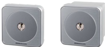
Ključno stikalo STAP 50 s tremi ključi, nadometna izvedba, mere: 80 × 80 × 63 mm (Š × V × G) Stopnja zaščite: IP 54
