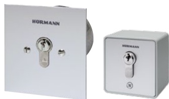
Stikalo na ključ ESU 30 s tremi ključi, podometna izvedba, možnost izbire impulzne ali odpiralno-zapiralne funkcije Mere stikalne doze: 60 mm (D), 58 mm (G) Mere pokrova: 90 × 100 mm (Š × V) Izsek v steni: 65 mm (D), 60 mm (G) Stopnja zaščite: IP 54
