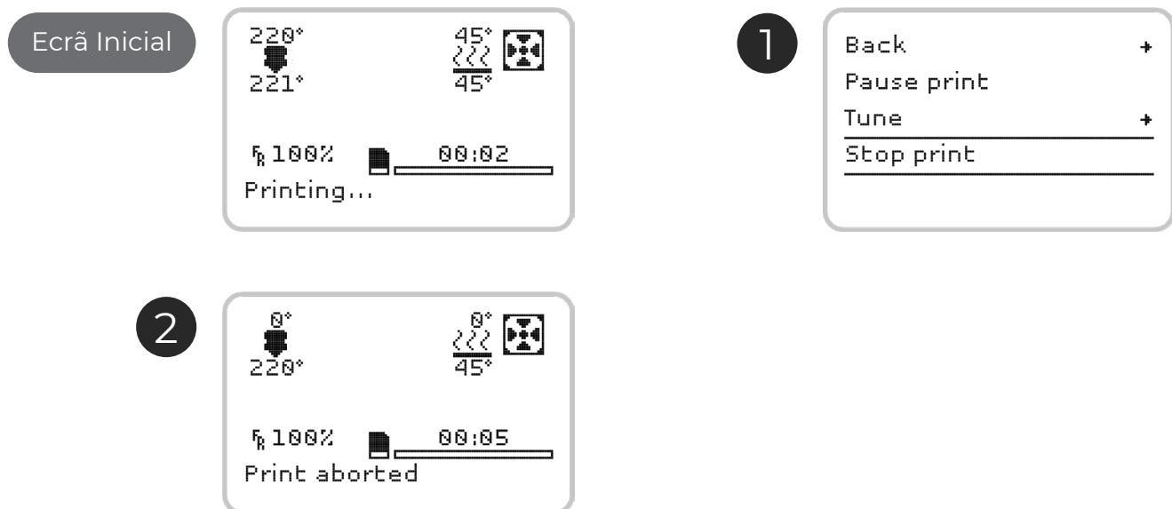
6. **Tune** - permite ao operador alterar directamente alguns parâmetros de impressão e trocar de filamento durante a impressão. A velocidade de impressão, a temperatura do Hot End, a temperatura da cama quente, a velocidade do Blower de arrefecimento e o fluxo de filamento podem ser estabelecidas ou alteradas.(Ecrãs ilustrados na próxima página)
