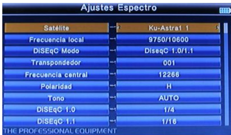
En esta pantalla se pueden ajustar directamente los parámetros del transponder concreto que se desea visualizar y medir al acceder al espectro. En caso de querer mostrar el espectro del satélite elegido mediante la opción DVB-S2 del menú principal, simplemente pulsar la tecla OK para acceder directamente al mismo sin necesidad de cambiar ninguna de estas opciones.
