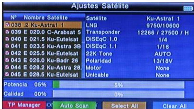
Mediante esta opción es posible elegir un satélite de la lista para orientar una antena parabólica, mostrándose de forma gráfica los valores de potencia y calidad de la señal.
