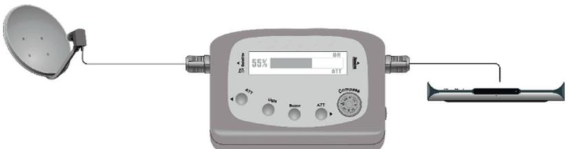
1. Schließen Sie das Koaxialkabel, welches vom LNB (der Satellitenschüssel) kommt, an die Satellite Buchse (1) des SAT FINDERS an.
