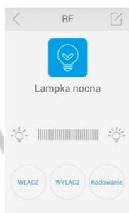
O LED irá iluminar o dobro, o que significa que a codificação do equipamento foi bem sucedida. Para ligar e desligar a fonte de luz basta pressionar um botão. Para escurecer ou clarear a fonte de luz, deslize o dedo ao longo da tira do dimmer.
