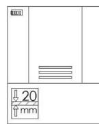
5. Neste momento, continuar a mover na mesma direção. Quando o instrumento deixar o centro do objeto medido, o ecrã exibirá a interface como na imagem (ao lado). Continuar a mover o instrumento para longe do bloco de madeira, o sinal diminuirá gradualmente até não haver sinal. O ecrã exibirá uma imagem idêntica (ver imagem ao lado), e a operação de deteção será concluída.
