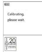
2. Ao detetar corpos estranhos, o instrumento deve ser fixo verticalmente à parede e, de seguida, premir o botão para detetar. Manter o instrumento imóvel durante 1-3s e a calibração do instrumento estará concluída antes de efetuar a operação de deteção (como indicado na imagem à esquerda). Colocar o sensor na superfície do objeto e deslocá-lo uniforme e lentamente na mesma direção, para a esquerda ou para a direita, sem levantar ou aplicar pressão adicional (imagem à direita).
