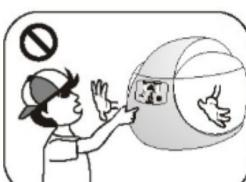
Não tocar no aparelho se este tiver caído na água. Desligar primeiro da corrente eléctrica.
