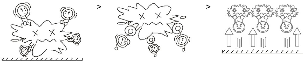
A ação das ondas ultrassónicas gera uma grande quantidade de bolhas na solução.
