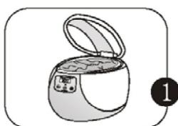
Abrir a tampa e encher o recipiente com água suficiente.
