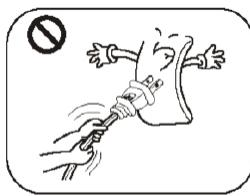
Não utilizar o aparelho em áreas onde existem produtos inflamáveis, líquidos, vapores ou dispositivos de oxigênio. Desligar o cabo de alimentação puxando pela ficha e não pelo cabo.
