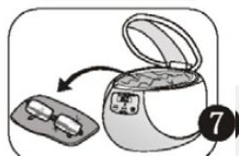
Quando o ciclo de limpeza estiver terminado, desligar o aparelho da tomada, abrir a tampa e remover os objetos limpos. Depois, despejar a água e limpar o recipiente de aço inoxidável com um pano macio.
