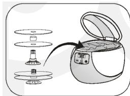
A limpeza manual dos discos com um pano pode riscar os discos. O método de limpeza por ultrassons é, por isso, ideal – em dois minutos, o disco é limpo. Colocar os discos (CD, VCD, DVD) no suporte como mostrado na imagem (podem ser limpos até dois discos ao mesmo tempo). De seguida, inserir o suporte com os discos no recipiente de aço inoxidável do aparelho de limpeza (previamente cheio com água da torneira).
