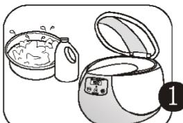
Após utilizar o aparelho, deitar fora a água e secar as superfícies interiores e exteriores com um pano seco. Por razões de segurança, não lavar o aparelho com água devido ao risco de choque-eléctrico.
