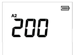
o valor pode ser ajustado com os botões ▲ e ▼, de seguida, pressionar demoradamente o botão [SET] para guardar o novo valor configurado. "S-1" será mostrado no ecrã se o valor for guardado com sucesso.
