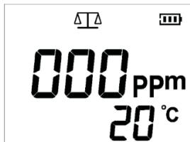
Após cerca de 10 minutos, se a leitura exibida não for 0 ppm, ajustar a leitura exibida para 0 ppm através dos botões **▲** e **▼** e pressionar demoradamente [SET] para guardar o valor. Quando o valor for guardado com sucesso, "S-1" será mostrado no ecrã. O ajuste a zero está concluído.
