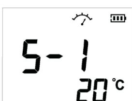
Até então, todo o procedimento de calibração, incluindo o ajuste a zero e a calibração, está concluído.
