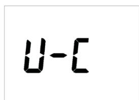
A definição do zero e a calibração do dispositivo devem ser efectuadas à temperatura ambiente (recomendado 20±2°C) quando a temperatura do dispositivo estiver próxima à temperatura ambiente (recomendado mais de 1 hora) para reduzir o erro devido à diferença de temperatura.
