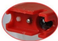
Eléctrodo Antes do primeiro uso, ative o eléctrodo do medidor de pH mergulhando-o numa solução saturada de KCl por 12 horas.
