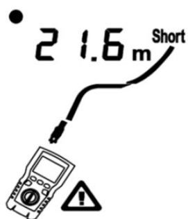
Figura 6.16: Curto-circuito no Cabo Coaxial
