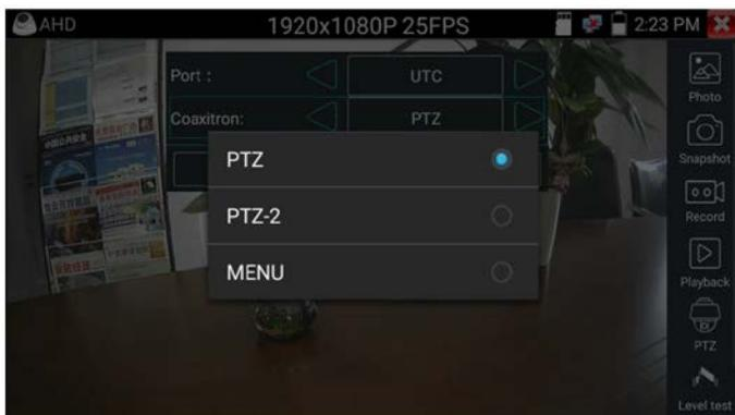
Se for utilizado controlo PTZ coaxial com a câmara AHD, não é necessário configurar quaisquer parâmetros.
