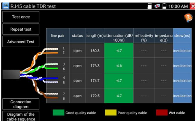
**Teste único:** Executa uma verificação única do estado do cabo, comprimento e atenuação.
