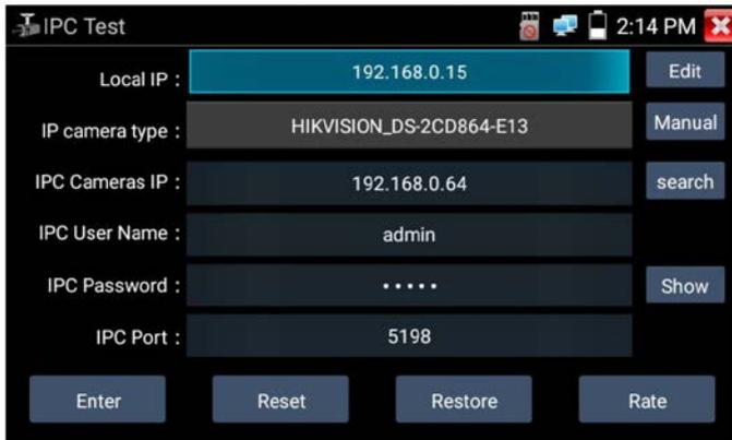
**IP Local:** Este é o endereço IP do testador. Clique em "Editar" para aceder às "Definições de IP" e alterar os parâmetros de endereço IP do testador.
